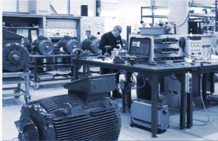
De "speed lijn" bestaat uit een werkeiland waaraan enkele stuks, grote aandrijvingen en spoedopdrachten kunnen worden verwerkt.
